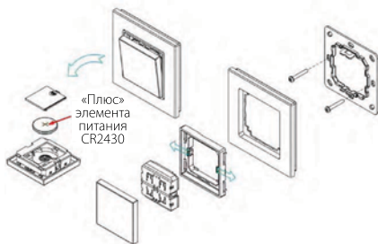
Рис. 1. Установка элемента питания и монтаж панели.
